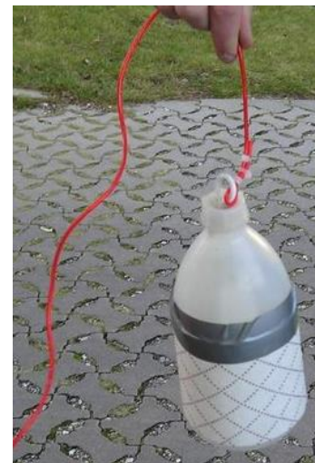
Бутылка для отбора проб биопленки – обернута бумагой -
